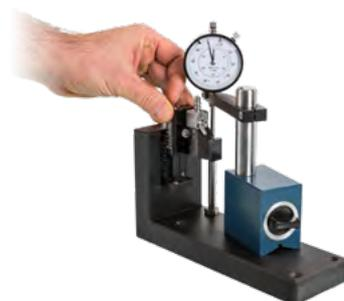
**2.** Posizionare l'utensile sul dispositivo e stringere leggermente la vite di bloccaggio fino a quando il supporto è inserito nel dispositivo senza gioco. Idealmente collocare l'altezza della punta leggermente al di sotto del centro, in modo da registrare avenga spingendo verso l'alto.
