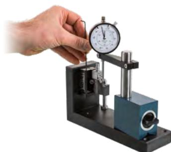
**4.** Régler la vis de réglage en hauteur jusqu'à ce que le comparateur soit réglé sur la cote zéro.
