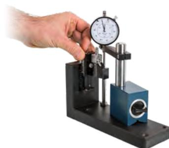
**2.** Placer le porte-outil sur le dispositif et serrer légèrement la vis de serrage jusqu'à ce que le support tienne sans jeu dans le dispositif. Idéalement, régler la hauteur de la pointe légèrement en dessous du centre afin que le porte-outil soit tiré vers le haut lors du réglage de la hauteur.
