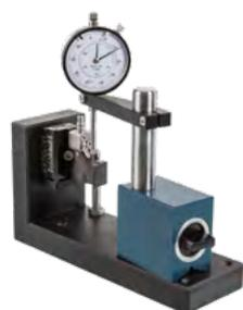
**3.** Placer avec précaution le comparateur à cadran sur la pointe de l'arête de coupe de l'outil.
