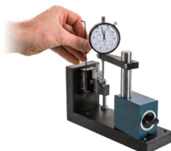
**4.** Registrare l'altezza tramite la vite fino a portare il comparatore sullo zero.
